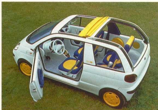
«Итал-дизайн-Люччоло». Прототип многоцелевого компактного автомобиля с трансформируемым кузовом. Энергетическая установка — дизель-генератор, выпрямитель, аккумуляторные батареи и тяговые электромоторы в колесах.
