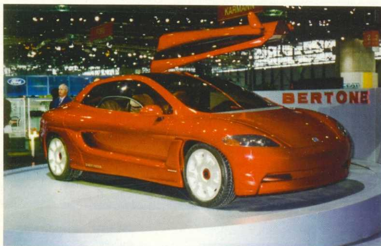
“Бертоне-Харизма”. Четырехместный задне-моторный седан с агрегатами “Порше-911” (прототип). Габарит — 4520х1860х1345 мм.
