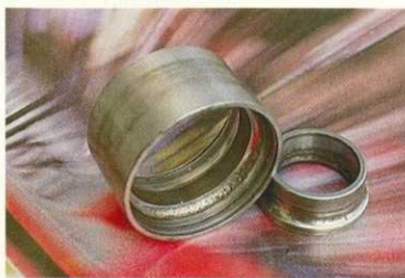
Типичное повреждение беговых дорожек подшипника (питтинг), вызывающее характерный шум.
