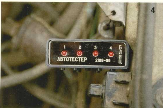
Фото 4. Миниатюрный автотестер "Блиц" в действии.
