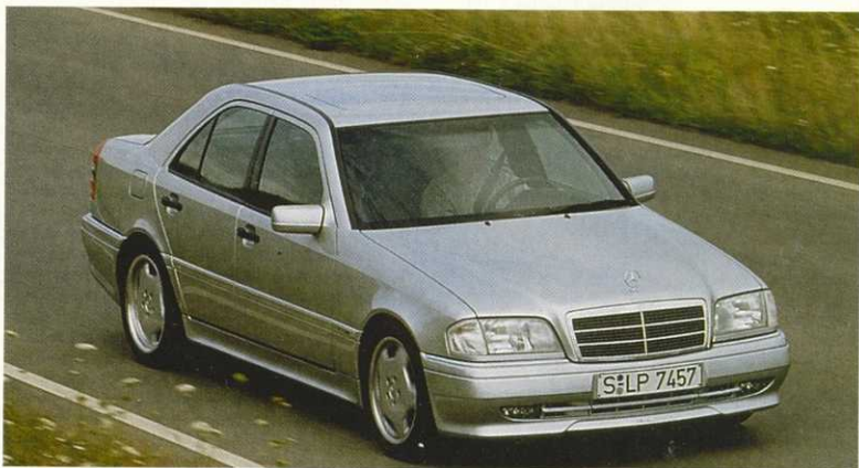
"Мерседес-Бенц-С36 AMG", 1993 г. Компактная машина для любителей комфортабельной скоростной езды. В числе стандартного оборудования — автоматическая коробка передач. Двигатель: 6 цил., 2606 см 3 , 280 л. с. Скорость ограничена до 250 км/ч.
