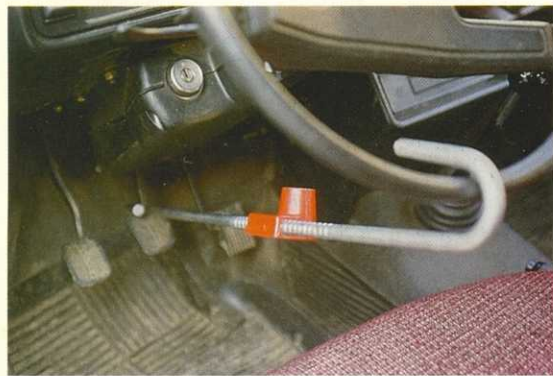
Фото 2. Мощные стальные прутки плотно охватывают обод и педаль. Однако на ВАЗ-2105 лучше зацепить крючок за спицу руля.
